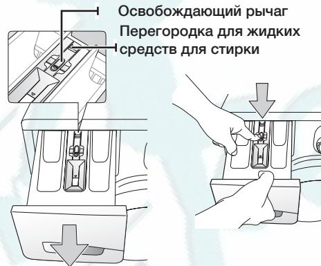
3. Промойте все части отсека проточной водой.
