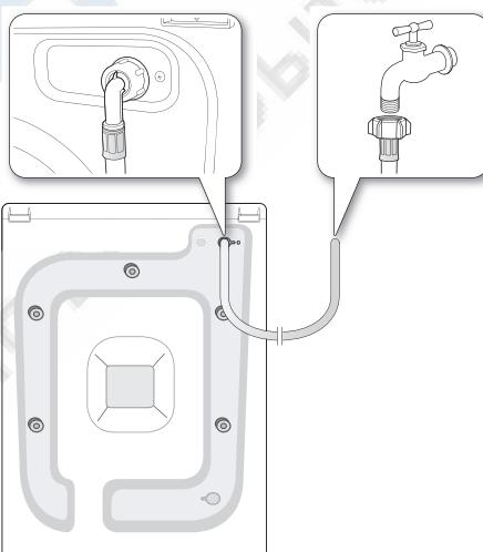
2. Подсоедините другой конец шланга подачи холодной воды к водопроводному крану с холодной водой и затяните соединение вручную. Если необходимо, можно изменить положение шланга подачи воды на стиральной машине. Для этого ослабьте соединение, поверните шланг и снова затяните соединение.
